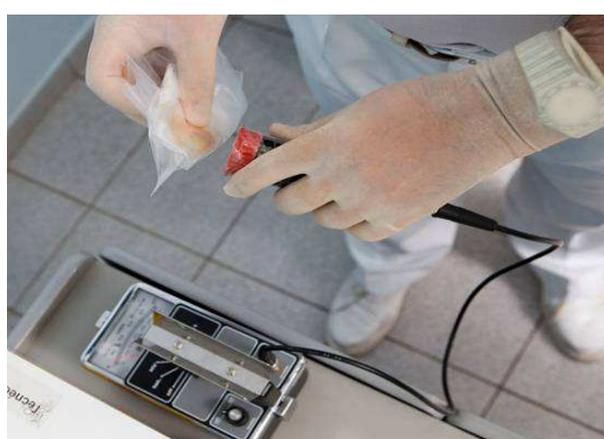
**Fig. 4.** Monitorização de gaze com contador *Geiger-Müller*.
